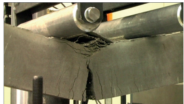
16 DUCON™-Element im statischen Biegezugversuch.
