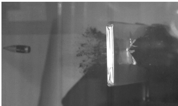
17 High-Speed-Aufnahmen vom Beschuss geladener Pouchzellen, links ohne Backing und rechts mit Stahlbacking.
