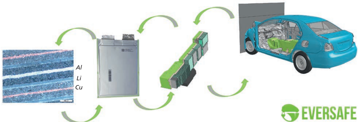
9 Aufgaben des Fraunhofer EMI im Projekt EVERSAFE: Von der Zellenanalyse über die Modellierung von Zellen, Zellmaterialien und Fahrzeugbatterien bis hin zur Simulation ganzer Fahrzeugmodelle unter beliebigen Crashfällen.
