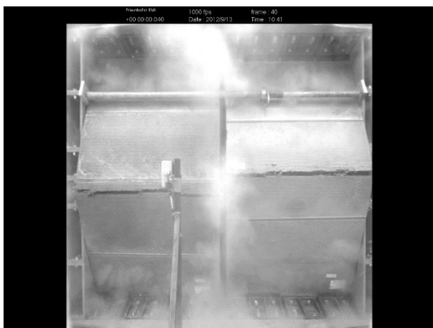
18 Bildabfolge eines Stoßrohrversuches an einen DUCON™-Element zu den Zeitpunkten (von links nach rechts, von oben nach unten) t = 0 \text{ ms} , 10 \text{ ms} , 20 \text{ ms} , 30 \text{ ms} , 40 \text{ ms} , 50 \text{ ms} .
