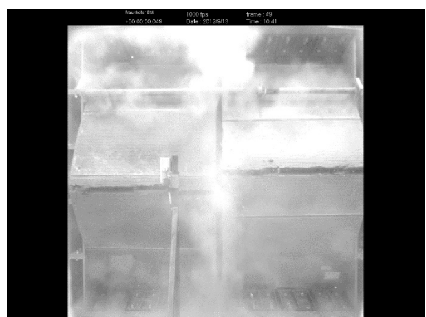
18 Bildabfolge eines Stoßrohrversuches an einen DUCON™-Element zu den Zeitpunkten (von links nach rechts, von oben nach unten) t = 0 \text{ ms} , 10 \text{ ms} , 20 \text{ ms} , 30 \text{ ms} , 40 \text{ ms} , 50 \text{ ms} .
