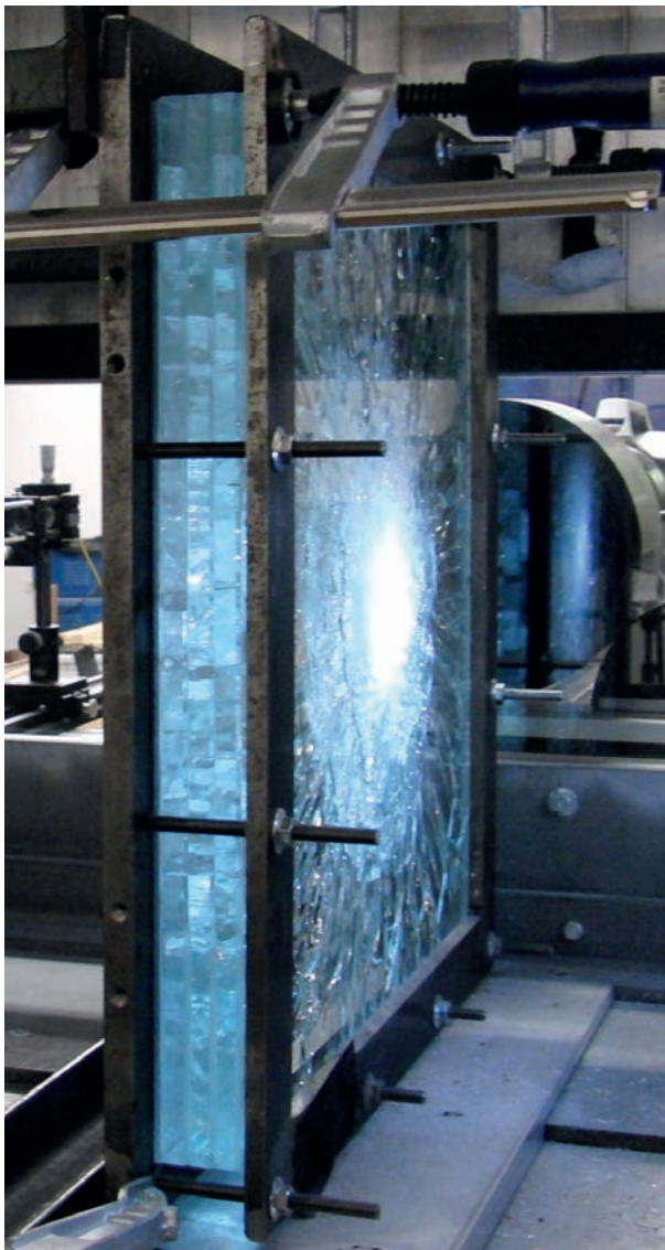
1 Schutzwirkung von Glaslaminaten beim Projektilimpakt.
